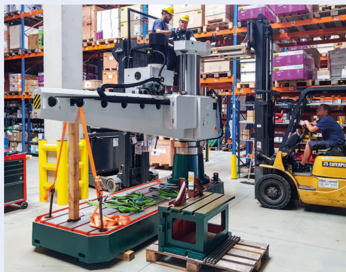
Radiální vrtačka může být už pořádně veliký stroj – např. VR 3070 váží 6 tun.
